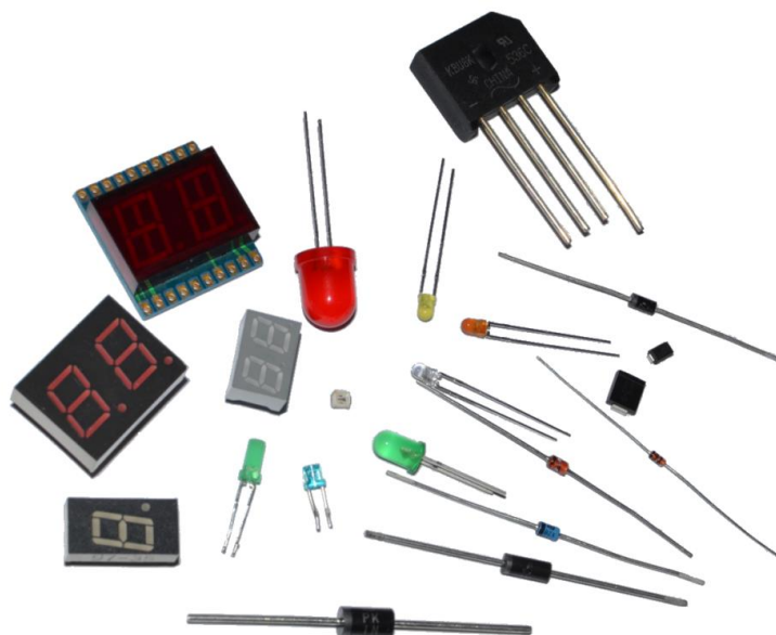
Obr. 5.10 Niektoré typy diód (vpravo hore so štyrmi vývodmi je usmerňovací mostík)[28]
